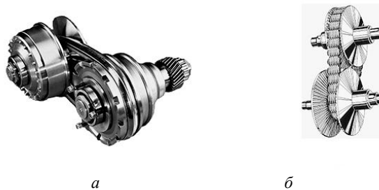
Рис. 1. Клиноременной и цепной вариатор: a – клиноременной вариатор; б – цепной вариатор
