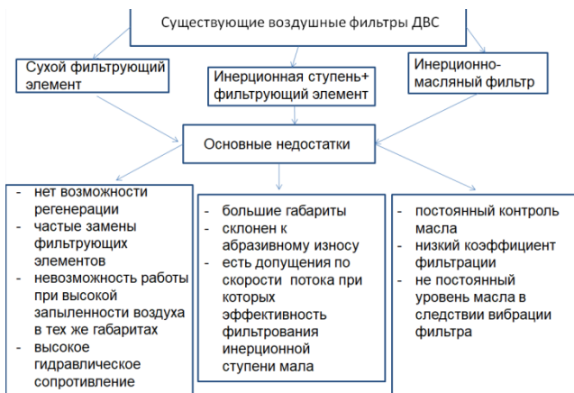
Рис. 1. Недостатки воздушных фильтров ДВС
