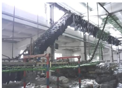
Рис. 1. Рабочий и холостой участки подвесного транспортера
