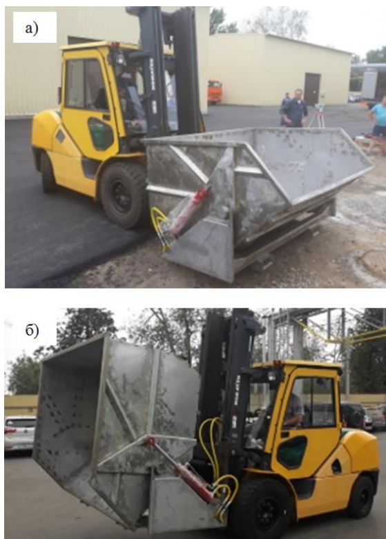
Рис. 1. Опрокидывающаяся емкость вилочного погрузчика в рабочем положении (а) и в процессе разгрузки (б)
