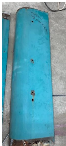
Рис. 3. Металлический лист обшивки кабины, подверженный действию коррозии
