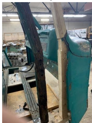
Рис. 2. Сгнившая деревянная правая стойка и установленная новая
