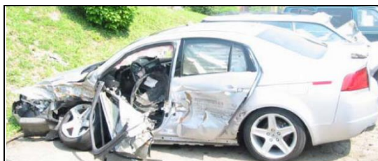
Рис. 1. Фронтальное столкновение с малым перекрытием
