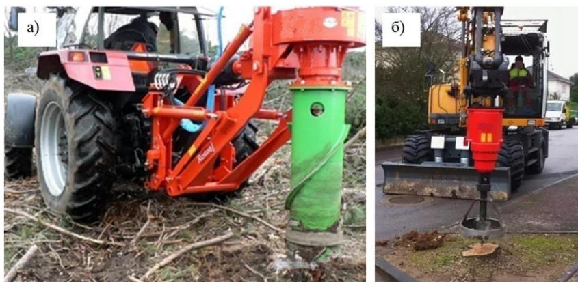
Рис. 1. Роторные измельчители пней на базе трактора (а) и на базе экскаватора (б)
